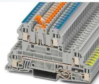
4 (4) мм 2 , 24 А, трехъярусная клемма, 1 проходной ярус L, 1 ярус N с размыкателем, 1 PE
