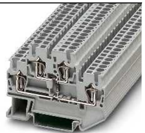
26 А, диодные двухъярусные клеммы, 1N 4007 (1300 В/0,5 А)
