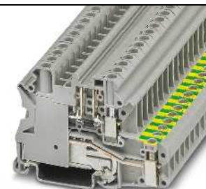
0,5 А, диодная клемма, 1N 4007 (1300 В/0,5 А), направление диода: справа налево
